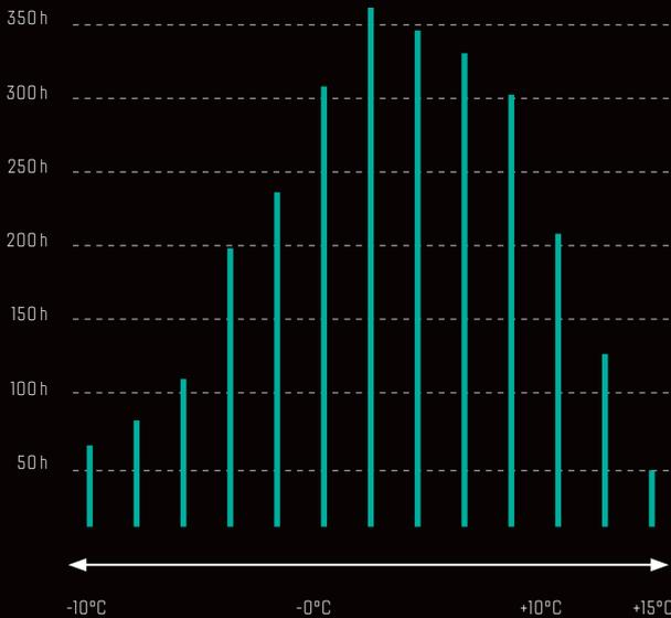
Dieser ist in der EN14825 geregelt und wird in einem aufwendigen Prüfverfahren in einem zertifizierten Prüfinstitut ermittelt. Dazu wird die Wärmepumpe bei verschiedenen Temperaturbereichen auf ihre Effizienz geprüft. Sowohl die Einsatzgrenze (bei  $-20^{\circ}\text{C}$ ), als auch die Prüfpunkte bei  $-10^{\circ}\text{C}$ ,  $-7^{\circ}\text{C}$ ,  $2^{\circ}\text{C}$ ,  $7^{\circ}\text{C}$  und  $12^{\circ}\text{C}$ , werden exakt vermessen.
